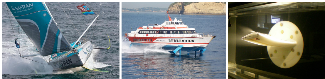
Navire de la course Vendée Globe 2015 / Hydroptère « Aldebaran » / Surface portante flexible sous écoulement (doc. Irenav)
